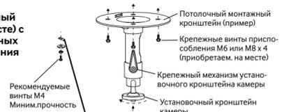
**[3] Ослабьте фиксирующий механизм установочного кронштейна камеры, чтобы установочный кронштейн камеры двигался свободно.**
