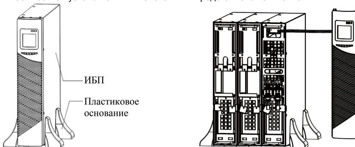
Рис.16 Установка ИБП и внешних аккумуляторных блоков
