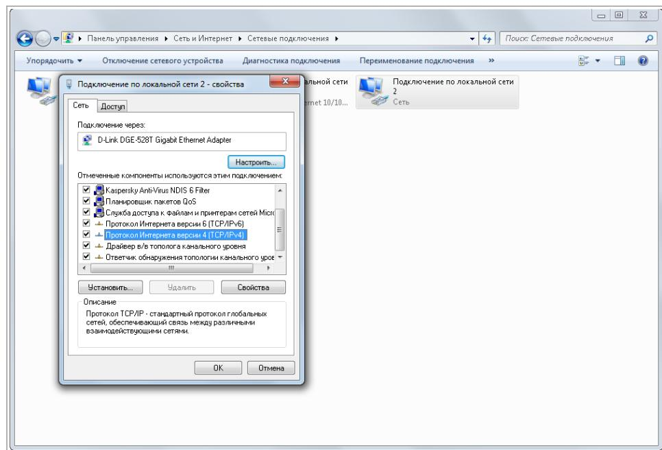
В окне свойств выделите компонент **Протокол Интернета версии 4 (TCP/IPv4)** и нажмите на кнопку **Свойства**. При этом откроется окно свойств протокола Интернет:
