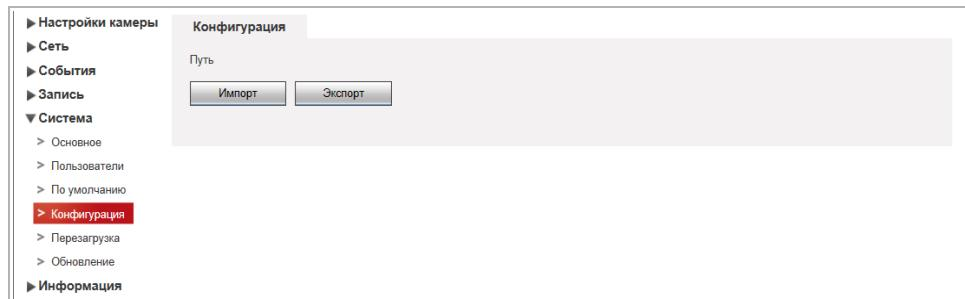
При нажатии на кнопку **Импорт [Import]** откроется диалог выбора файла с ранее сохраненной конфигурацией настроек IP-камеры. После выбора файла произойдет загрузка, текущие настройки при этом будут заменены.
