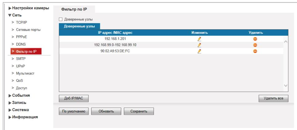
Если установлен флаг **Доверенные узлы [Trusted Sites]**, то доступ к IP-камере будет возможен только с сетевых устройств, сетевые параметры которых указаны в списке ниже. Если флаг снят, то подключится к камере можно с любого сетевого устройства.
