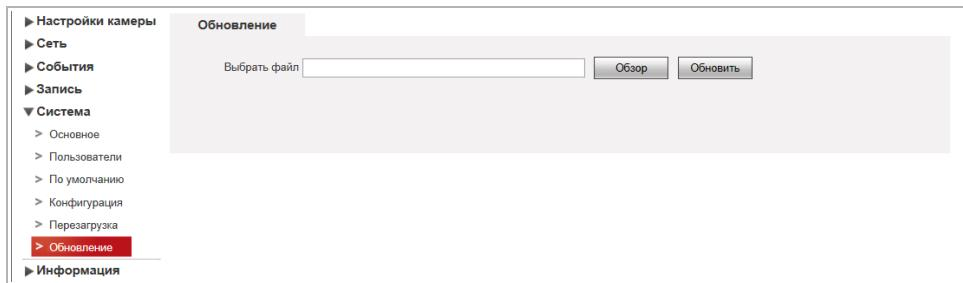
Для обновления программного обеспечения (прошивки) IP-камеры нажмите кнопку *Обзор [Browse]* и укажите файл с программным обеспечением. Чтобы начать загрузку файла нажмите кнопку *Обновить [Upgrade]*.
