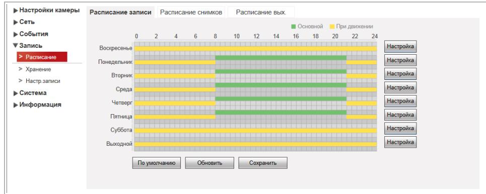
Для того чтобы определить интервал времени, в время которого будет действовать одна из выбранных настроек записи нажмите кнопку **Настройка [Setup]** напротив настраиваемого дня недели.
