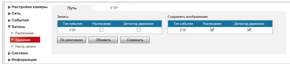
В таблицах *Запись [Record]* и *Сохранить изображение [Snapshot]* установите флаг для сохранения видеоархива и снимков на FTP-сервере, в зависимости от типа снимаемой ситуации:
