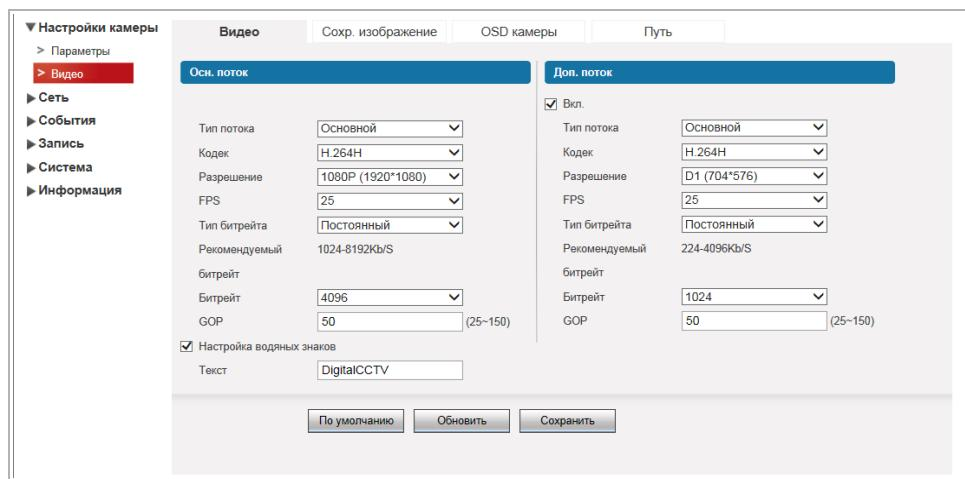
Чтобы включить передачу по дополнительному потоку (субпотоку) установите флаг *Вкл. [Enable]*.
