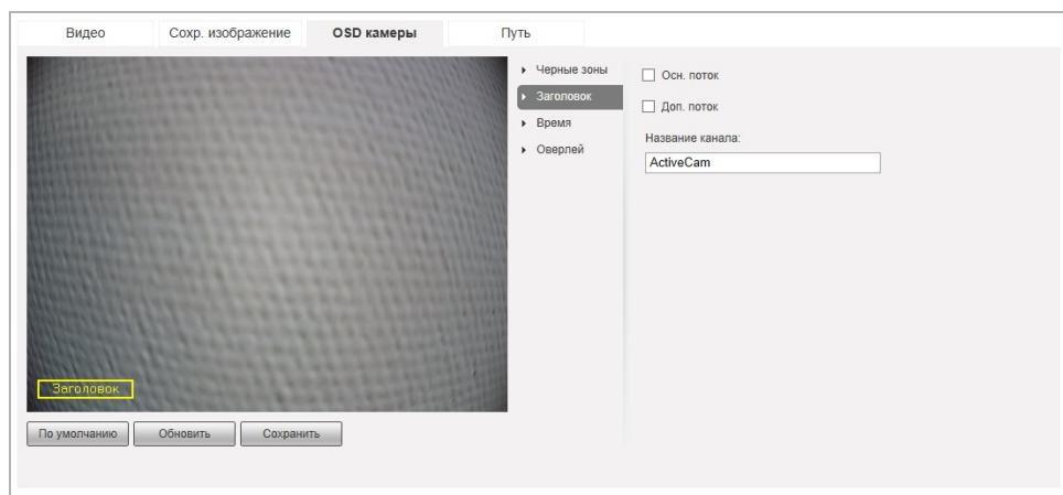
Для включения отображения даты и времени записи на видеоизображении выберите пункт **Время [Time Title]**. При помощи мыши перетащите прямоугольник в нужное положение на изображении. Установив флаги **Осн.поток [Main Stream]** и/или **Доп.поток [Sub Stream]**, выберите потоки, на которых будет отображаться заголовок. Установите флаг **День недели [Week Display]** для включения отображения дня недели.
