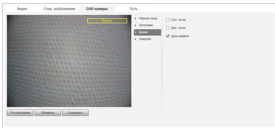
Для отображения на изображении произвольного текста выберите пункт **Оверлей [Overlay]**. При помощи мыши перетащите прямоугольник в нужное положение на изображении и выберите **Вкл [Enable]**. В **Поле ввода [Input Text]** введите отображаемый текст. **Выравнивание [Text Align]** позволяет выравнять текст **По прав.краю [Right]** или **По лев.краю [Left]**.
