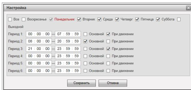
Каждый день недели может разбить на 6 интервалов и для каждого выбрать время его начала и конца. А так же определить один из вариантов настройки, при выполнении которой будет производится запись видео с камеры:
